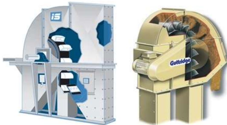
แสดงส่วนหัว (Head) ที่เป็นตำแหน่งจ่าย (Discharge) วัสดุ
