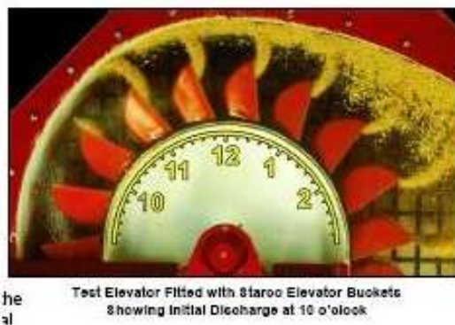
รูปแสดงการจ่ายวัสดุแบบแรงเหวี่ยงหนีศูนย์กลาง (Centrifugal Discharge Elevator)
